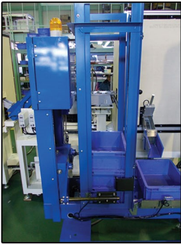
箱替え装置 ケースストックер Yutaka's fully automatic case stocker
