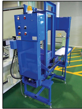
箱替え装置 ケースストックер Yutaka's fully automatic case stocker
